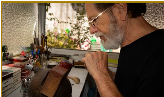
Manejo de la pez roja, una amalgama utilizada para fijar las piezas durante el trabajo de damasquinado. Amable Rodríguez. Maestro damasquinador en su taller.
